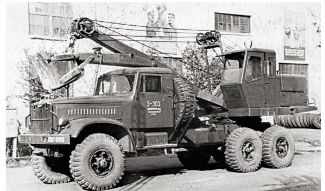
Экскаватор Э-305 на базе ЯАЗ-214 с оборудованием «прямой лопаты»
