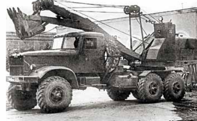
Экскаватор Э-305В с кабиной экскаваторщика в специальном исполнении
