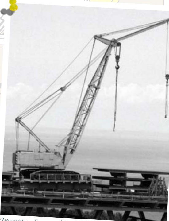
Гусеничный кран KC-8161 со стрелой, оснащенной 10-метровым троском
