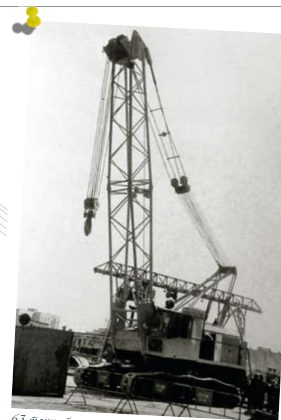
63-тонный гусеничный кран КС-7163, серийный выпуск которого начал в 1983 году
